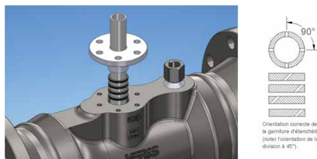
Figure 4. Installation des bagues d'étanchéité
